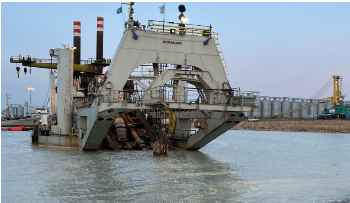
36-сурет. Құрық портында (Маңғыстау облысы) ірі тоннажды кемелердің шығуын қамтамасыз ету үшін тереңдету жұмыстары жүргізілуде 77
